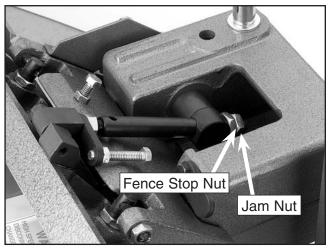
Figure 48. 45° inward fence stop jam nut.
